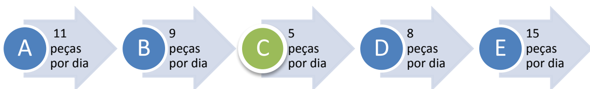
Figura 6 – Restrição em um processo produtivo – a restrição é representada pela atividade C do processo, onde são produzidas 5 peças por dia, limitando todo o sistema a esta restrição
